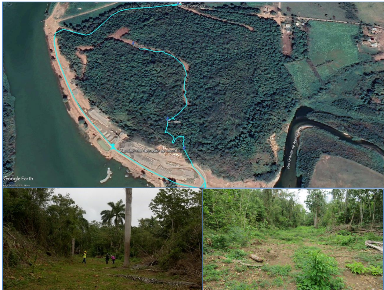
Imagen 3. Camino construido en el lado oeste fue conectado con un camino antiguo en la cima del mogote. Ancho promedio es de 12 metros y aproximadamente 1 kilómetro de largo.
